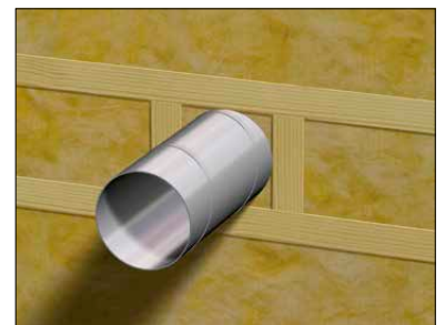
Avväxling runt genomföring
