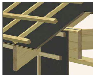
Övergång vägg/tak med utstickande takstolar/takbalkar
